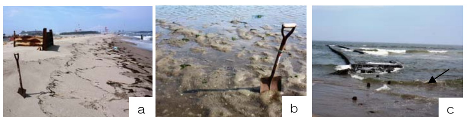
Fig.4 当日の画像 a:高さをます砂州のクレスト b:クレストが消失しかけたカレントリップル c:海中の導流堤から回り込む波（写真の位置はfig.3のa~c）
